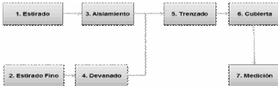
Diagrama 1. Proceso de producción de cable coaxial
