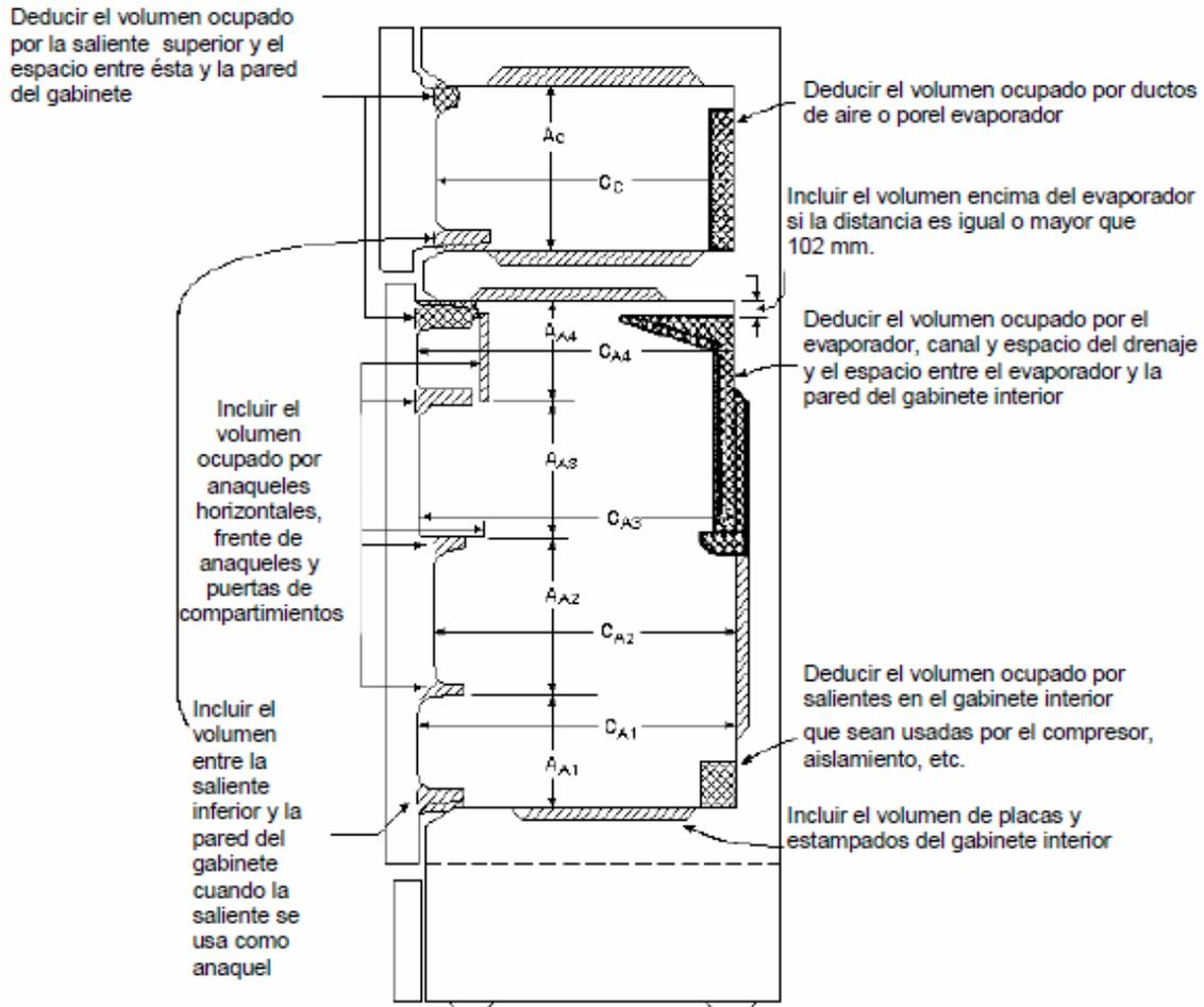
Figura 8. Refrigerador-congelador con el compartimiento congelador montado en la parte superior
