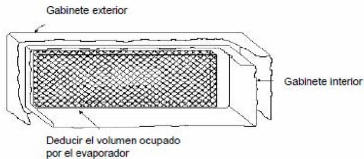
Figura 16. Volumen ocupado por el evaporador en el compartimiento congelador en sistemas de aire forzado
