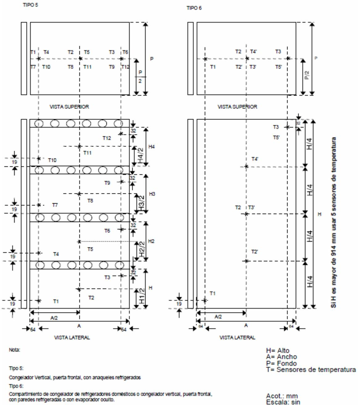
Si un saliente en el lado interno de la puerta interfiere con la localización del sensor de temperatura, el sensor se colocará en un lugar lo más cercano al especificado.
