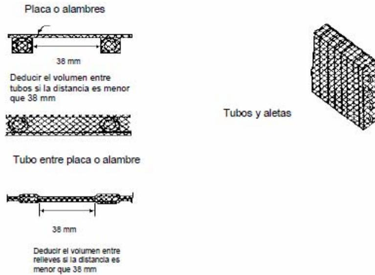
Figura 14. Tipos de evaporadores
