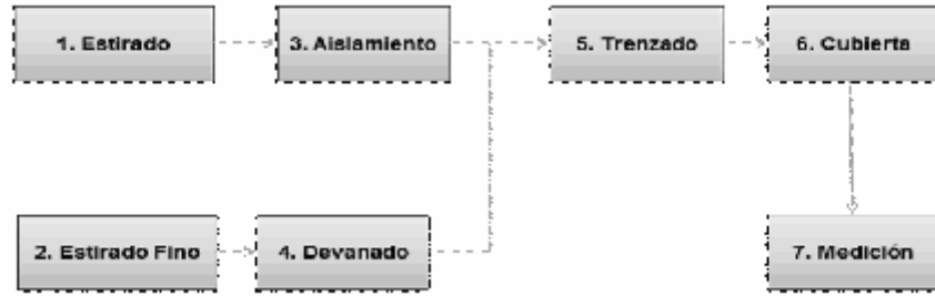
Diagrama 1. Proceso de producción de cable coaxial
