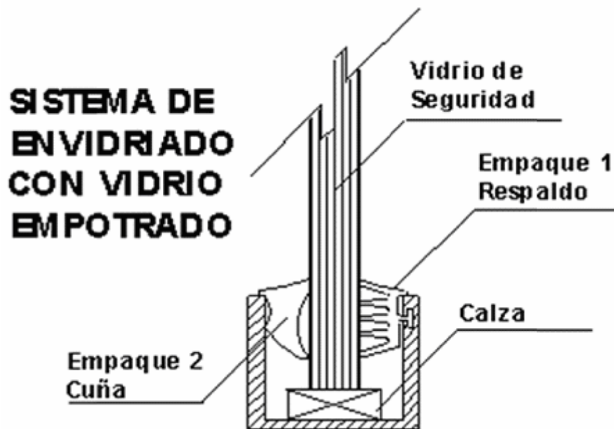
Figura 6.- Sistema de envidriado
