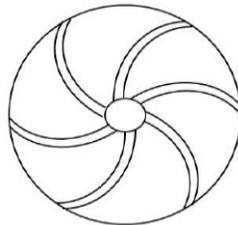
Figura 1.- Impulsor centrífugo
